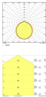
Scheda tecnica Ledvance Bulkhead LED Surface Circolare 42W 3500lm - 830 Luce Calda | 500mm - IP44 - Dali Dimmerabile
