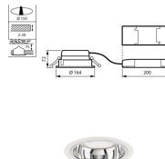
Scheda tecnica Philips Downlight LED LuxSpace Mini DN560B 9W 1350lm 80D - 830 Luce Calda | 164mm - Aluminium Riflettore - Emergenza 3H
